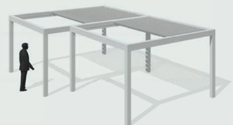
Struttura realizzata accoppiando moduli con profondità diverse Structure made with modules of different depth
