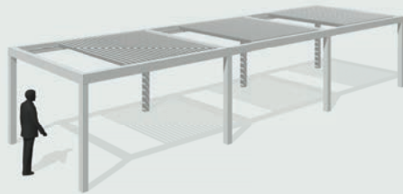
Struttura autoportante con moduli affiancati sul lato della larghezza Self-supporting structure with modules, flanked on the width side
