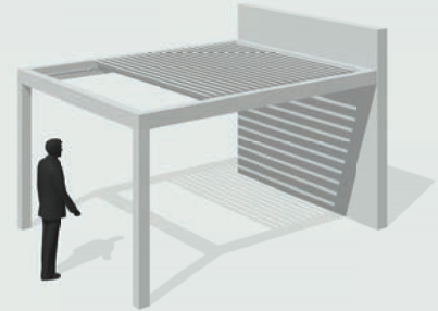
Struttura addossata a muro lato profondità Structure leaning against a wall, depth side
